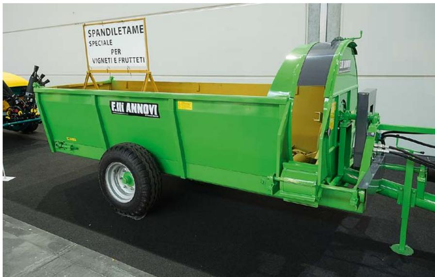
Компактный разбрасыватель навоза/компоста мод. А 25 производства «Annovi F.lli di Annovi Marino srl» предназначен для использования на виноградниках, в садах и теплицах при выращивании фруктов и овощей. Основные технические характеристики: габариты (ширина × длина × высота) 145 × 460 × 142 см, объём бункера 2,2 м³, диаметр турбины 105 см. Данная машина позволяет регулировать интенсивность и площадь внесения в почву органических удобрений
